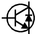
Certain transistor, surtout le transistor de déflexion et une très large sélection de darlington possède une diode de protection a l'intérieur du boitier connecté entre le collecteur et émetteur. Le BU505DF
