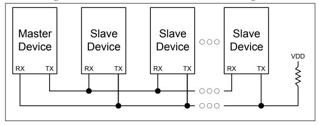
Figure 18.7. UART Multi-Processor Mode Interconnect Diagram
