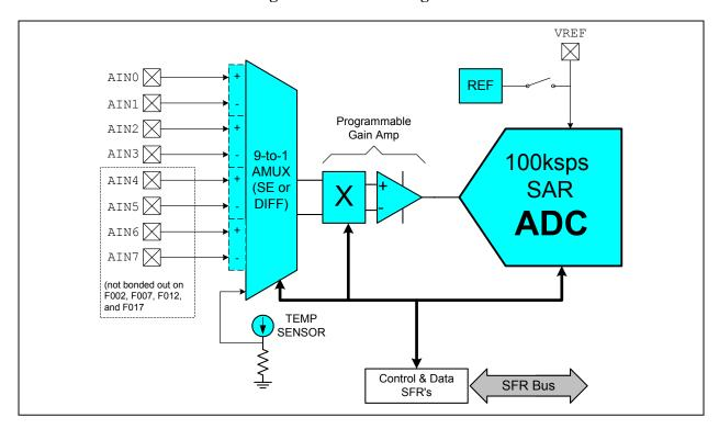
Figure 1.10. ADC Diagram
