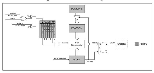
Figure 20.6. PCA PWM Mode Diagram
