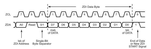
Figure 42. ZDI Single-Byte Data Read Timing
