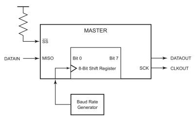
Figure 27. SPI Master Device
