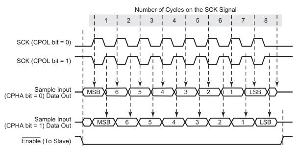
Figure 29. SPI Timing
