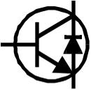
Einige Transistoren, insbesondere Ablenktransistore für Kathodenstrahlröhren und viele große Darlington-Transistoren verfügen innerhalb des Gehäuses über eine Schutzdiode, die zwischen Kollektor und Emitter angeschlossen ist. Ein typisches Beispiel für einen Bipolartransistor mit Schutzdiode ist der Philips BU505DF. Beachten Sie, dass Schutzdioden immer intern so zwischen Kollektor und Emitter angeschlossen sind, dass sie normalerweise in
