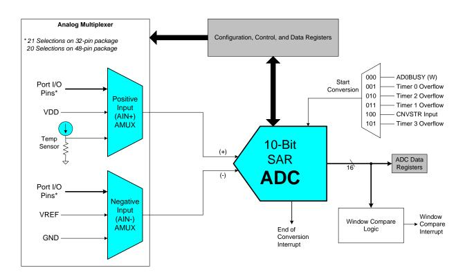
Figure 1.12. 10-Bit ADC Block Diagram
