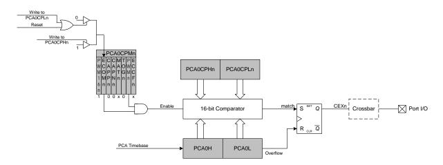
Figure 22.9. PCA 16-Bit PWM Mode
