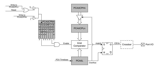
Figure 22.8. PCA 8-Bit PWM Mode Diagram
