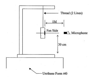
1 METER FROM MICROPHONE TO FAN INTAKE
