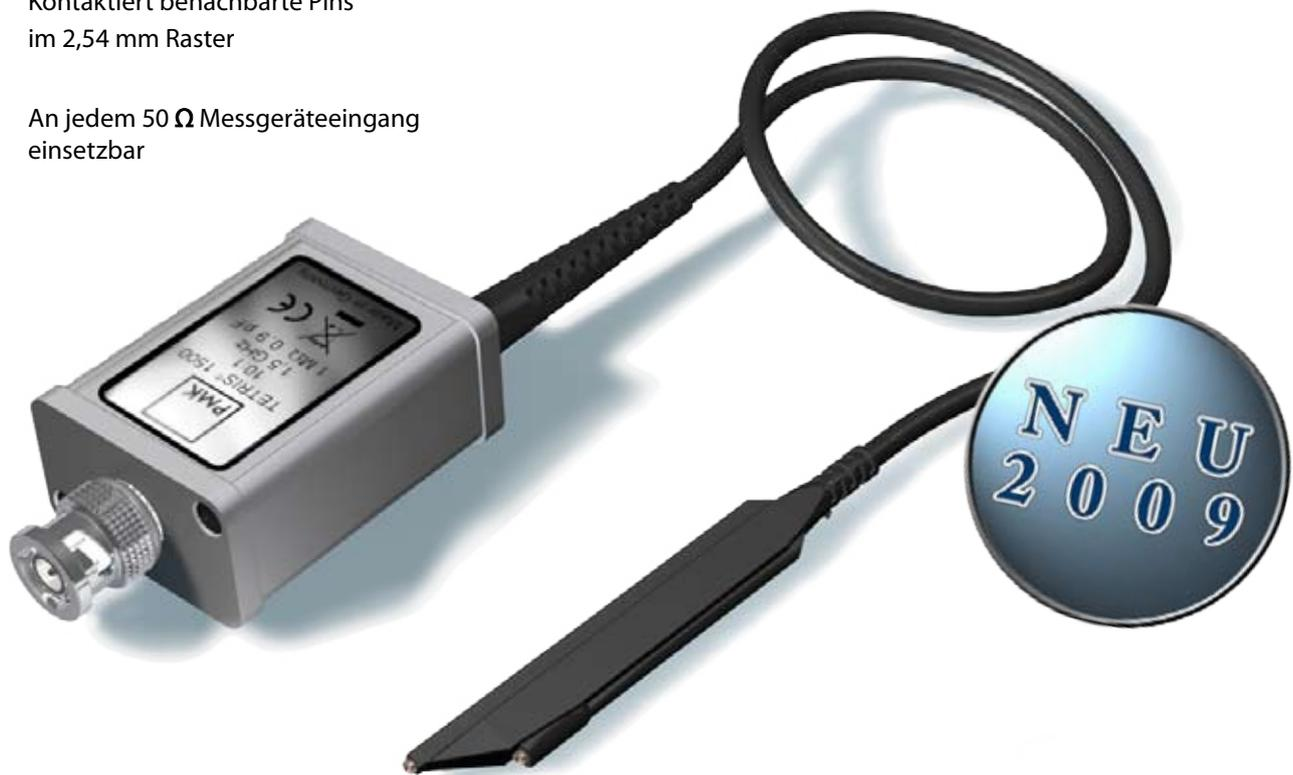
PMK präsentiert mit dem TETRIS® Aktiv-Tastkopf ein einzigartiges Inline Probing System, welches das gleichzeitige Kontaktieren benachbarter Pins im 2,54 mm Raster ermöglicht. Das patentierte Tastkopf-Gehäuse ist im T-Profil ausgeführt, sodass die Tastköpfe in einer unendlichen Kette nebeneinander auf Stiftleisten aufgesteckt werden können. So können problemlos viele Messungen gleichzeitig und parallel erfolgen.
