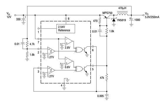
Figure 27. Step-Down Converter
