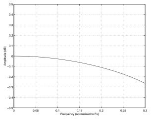
Figure 27. Quad-Speed (slow) Passband Detail
