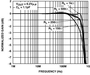
FIGURE 5. GAIN vs FREQUENCY vs R<sub>I</sub>
