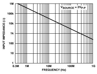
FIGURE 9. Z<sub>IN</sub> vs FREQUENCY
