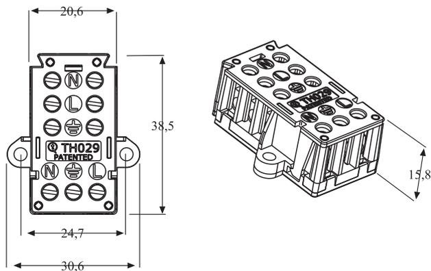
Capacità di connessione fino a 6<sup>□</sup>
