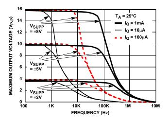
FIGURE 17. OUTPUT VOLTAGE vs FREQUENCY
