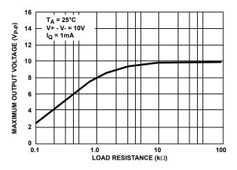
FIGURE 23. OUTPUT VOLTAGE vs LOAD RESISTANCE
