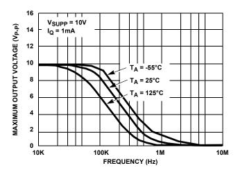
FIGURE 18. OUTPUT VOLTAGE vs FREQUENCY
