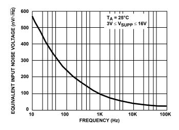
FIGURE 16. EQUIVALENT INPUT NOISE VOLTAGE vs FREQUENCY
