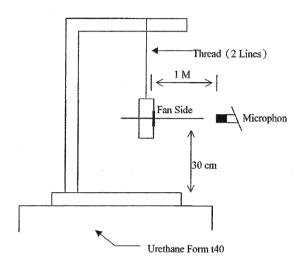
1 METER FROM MICROPHONE TO FAN INTAKE
