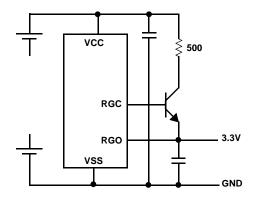
FIGURE 2. VOLTAGE REGULATOR CIRCUITS
