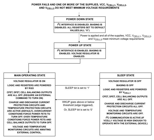
FIGURE 14. DEVICE OPERATION STATE MACHINE
