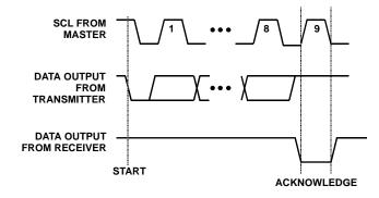
FIGURE 11. ACKNOWLEDGE RESPONSE FROM RECEIVER
