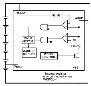
FIGURE 3. WAKE UP CONTROL CIRCUITS
