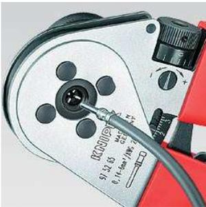
Vierdornpressung für zuverlässige Crimpverbindung
