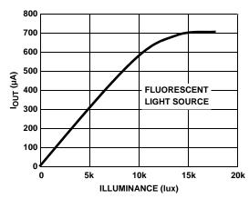
FIGURE 8. I<sub>OUT</sub> vs LUMINANCE
