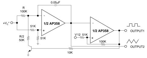
\*WIDE CONTROL VOLTAGE RANGE: 0  $V_{DC} \le V_C \le 2 (V^+ -1.5 V_{DC})$
