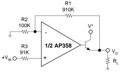
$V_{O}=0$   $V_{DC}$  for  $V_{IN}=0$   $V_{DC}$
