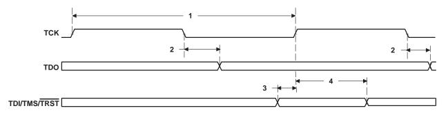
Figure 41. JTAG Test-Port Timing
