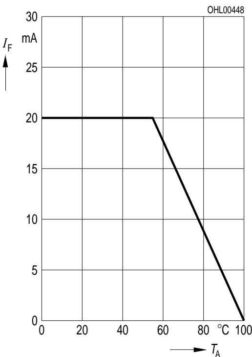
Maximal zulässiger Durchlaßstrom Max. permissible forward current I_F = f(T_A)
