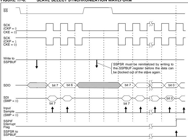
**FIGURE 17-6:** SLAVE SELECT SYNCHRONIZATION WAVEFORM
