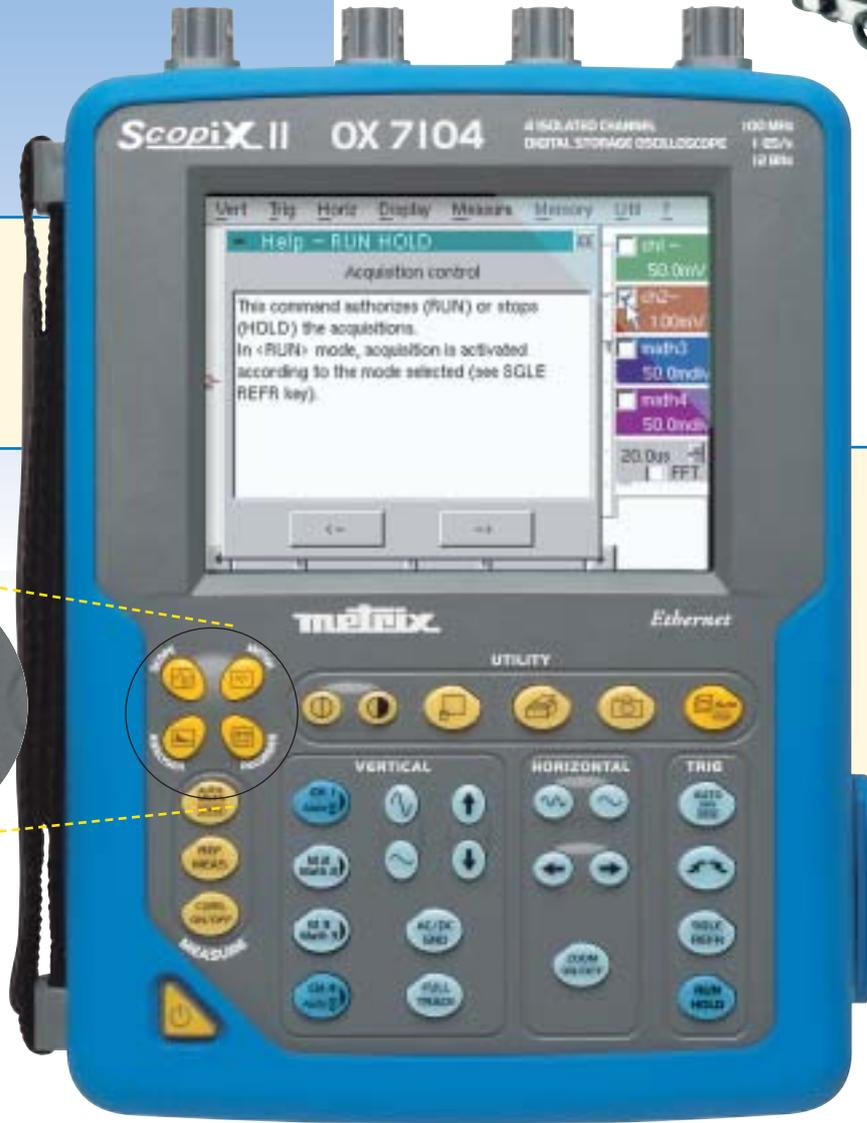
Les modes oscilloscope, multimètre, analyseur d'harmoniques, et enregistreur sont directement accessibles sur la face avant de l'instrument.
