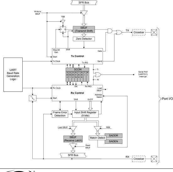
Figure 21.1. UART1 Block Diagram
