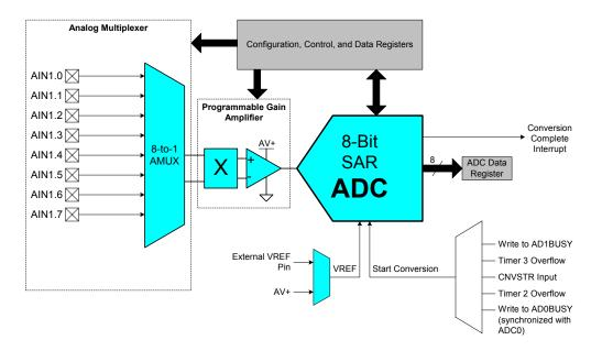
Figure 1.12. 8-Bit ADC Diagram
