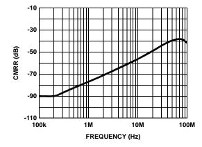
FIGURE 9. COMMON-MODE REJECTION RATIO vs FREQUENCY
