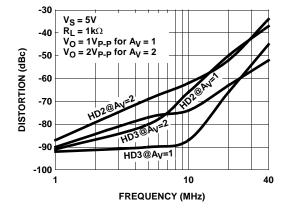
FIGURE 16. HARMONIC DISTORTION vs FREQUENCY
