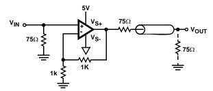
FIGURE 27. SYNC PULSE REMOVER
