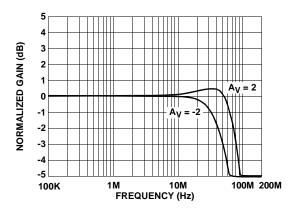
FIGURE 33. VIDEO LINE DRIVER FREQUENCY RESPONSE
