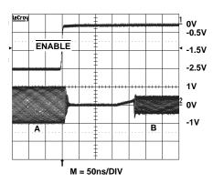
FIGURE 30. ENABLE SIGNAL
