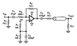
FIGURE 32. 5V SINGLE SUPPLY INVERTING VIDEO LINE DRIVER
