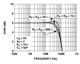
FIGURE 7. SMALL SIGNAL FREQUENCY RESPONSE FOR VARIOUS  $\rm R_F$  AND  $\rm R_G$
